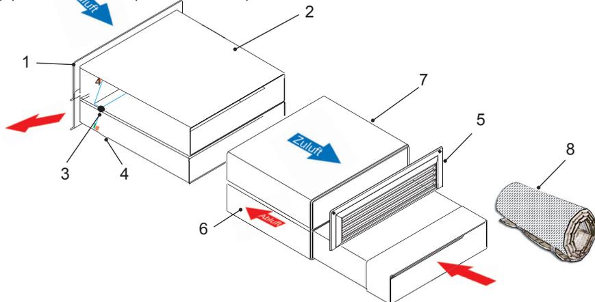
Die Abluft strömt durch den Kanal nach außen während sich in der Funktionseinheit (2) die kombinierte Rückstauklappe für die Abluft als auch Zuluft öffnet. Über den Zuluftkanal gleichen Querschnitts strömt parallel die gleiche Menge an Luft von außen nach innen. Das Zulufgitter (5) wird an der Kücheninnenwand an den Zuluftkanal (7) bündig angeschraubt.
